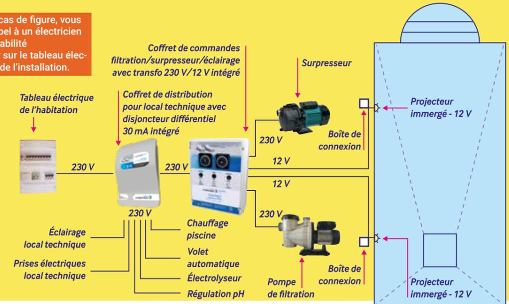
Schéma de principe de l'installation électrique
